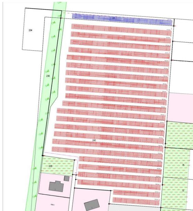
Abbildung 2: Modulbelegungsplan für die Südausrichtung ( $185^\circ$ ) (Quelle: Auftraggeber)
