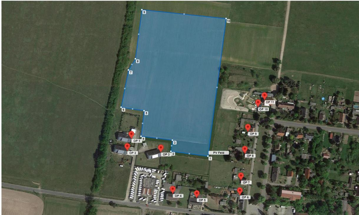
Abbildung 12: Anlage der PV-Flächen und Immissionsorte in der Simulationssoftware ForgeSolar
