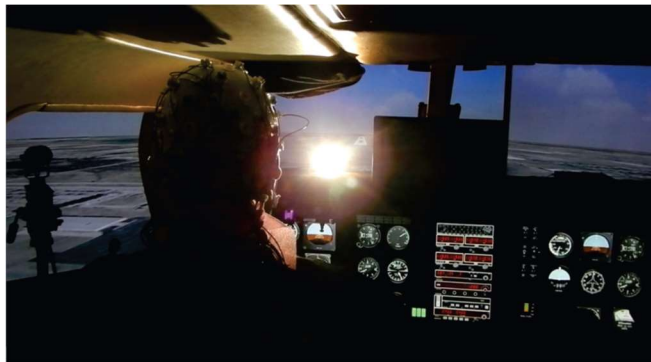
Abbildung 5: Darstellung einer Blendwirkung im relevanten Sichtfeld - Quelle: [9]
